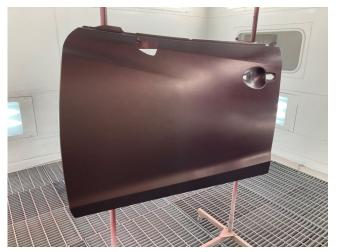
\*最後にエア圧を1. Obar以下にしてドロップコートを 最終ボカシェリアを超えて、広げながら1~2コート塗装する ことを推奨。
